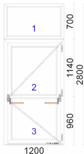
Portoncino d'ingresso ad un'anta con apertura a spingere Dx vista interna con sopra-luce fisso
