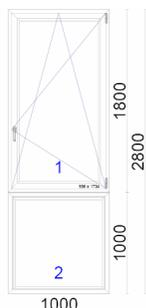
Finestra ad un'anta con ribalta Dx e sottoluca fisso
