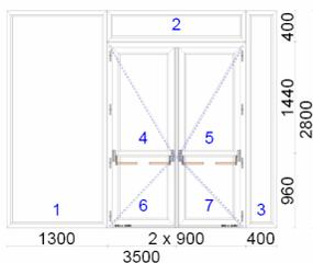
Portoncino d'ingresso a due ante con apertura a spingere Dx vista interna con sopra-luce fisso e due specchiature fisse laterali
