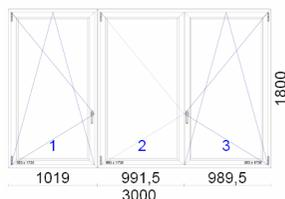
Finestra ad un'anta con ribalta Sx e finestra a due ante con ribalta Dx
