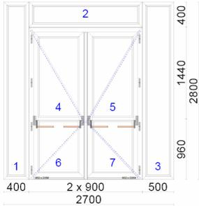
Portoncino d'ingresso a due ante con apertura a spingere Dx vista interna con sopraluce fisso e due specchiature fisse laterali
